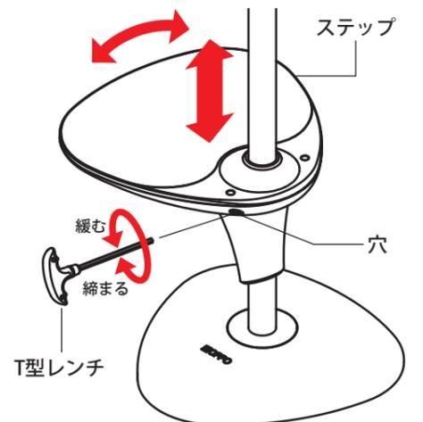
ステップの穴にT型レンチを真っ直ぐ差し込みネジを緩めます。
